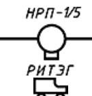
5. Передвижная усилительная станция (ПУС) линии передачи
