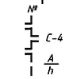
25. Линия стоечная городских телефонных сетей и сетей проводного вещания, км); номера опор, при необходимости, (1, 2, 3)
