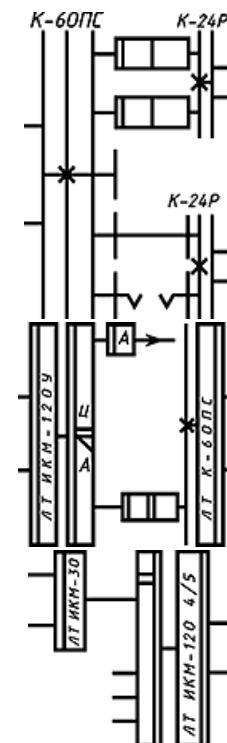
1.8. Сопряжение аппаратуры СП ИКМ-120 4/5 по однокабельной схеме с АТСК-У (основное обозначение)
