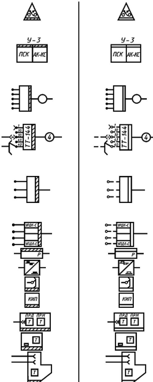
5. Аппаратура образования дискретных каналов местных телеграфных связей
